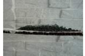
④最終的に約40倍に膨張し、断熱性に優れた炭化層を形成する
