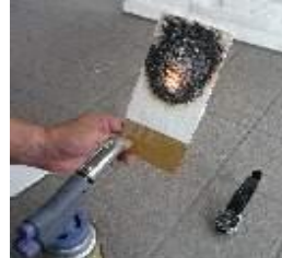
③炭化物を生成しさらに発泡が進む
